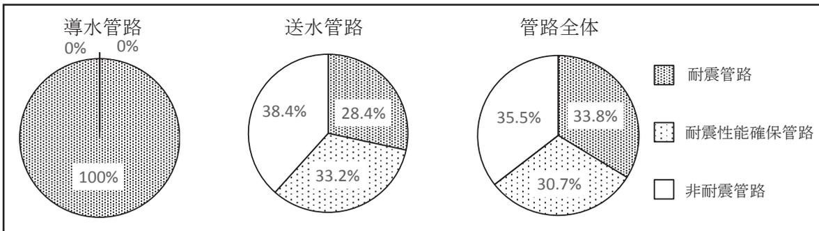
※ 耐震性能確保管路とは、管種自体は耐震管ではないが、良質地盤に埋設されていることから、耐震性能が確保されている管路のことです。
